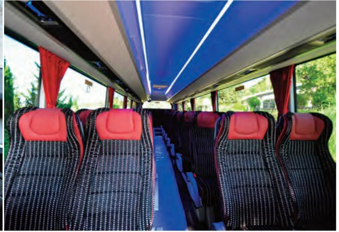
plano en la zona de pasajeros. Para acomodar a sus 39 pasajeros, el Otokar Ulyso viene equipado con unas excelentes butacas de la marca SEGE modelo Bus Confort 4030X VIP reclinables y desplazables con cinturones de seguridad de dos puntos, mesita, revistero y reposa pies.
