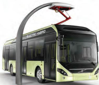
**Flexibilidad en el funcionamiento:** El Volvo 7900 Híbrido Eléctrico puede funcionar como un autobús eléctrico en determinadas zonas alcanzando hasta un 70% en modo eléctrico y como un vehículo híbrido en cualquier otra vía sin acceso a estaciones de carga, lo que le permite una flexibilidad en la operación indiscutible.
