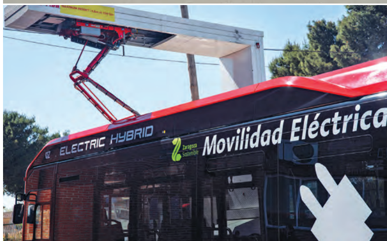
El autobús Volvo 7900 Híbrido Eléctrico recargando las baterías con el pantógrafo de ABB en tan solo seis minutos
