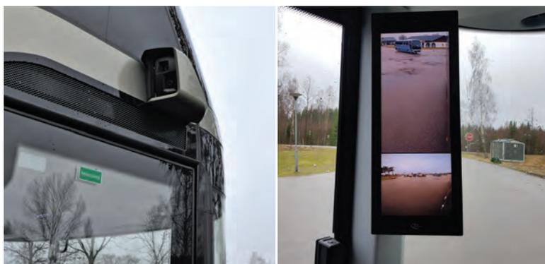
Sistema de visión con cámara MAN OptiView, que sustituye al retrovisor exterior.
