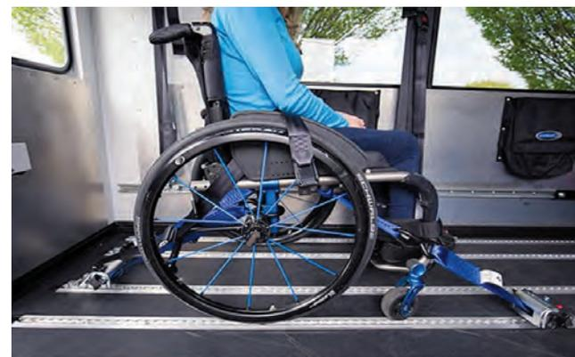
Sistemas de anclajes para silla de ruedas de IRC.
