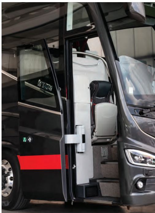
Puerta Swyncro de apertura al exterior.
