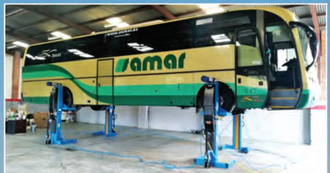
COLUMNAS CON CABLES O SIN CABLE SEGÚN SUS NECESIDADES
