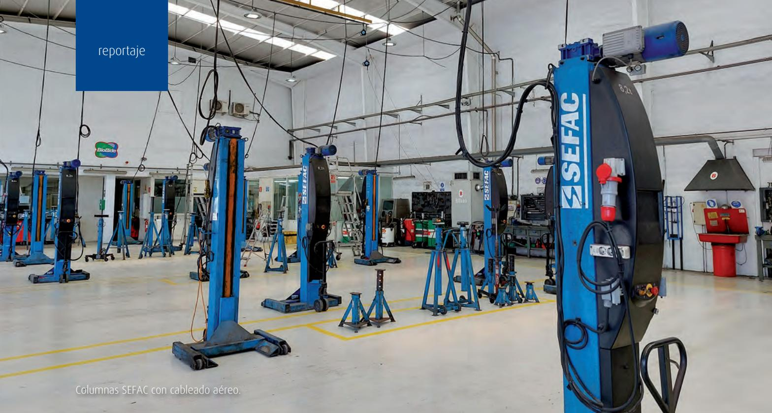
Columnas SEFAC con cableado aéreo.
