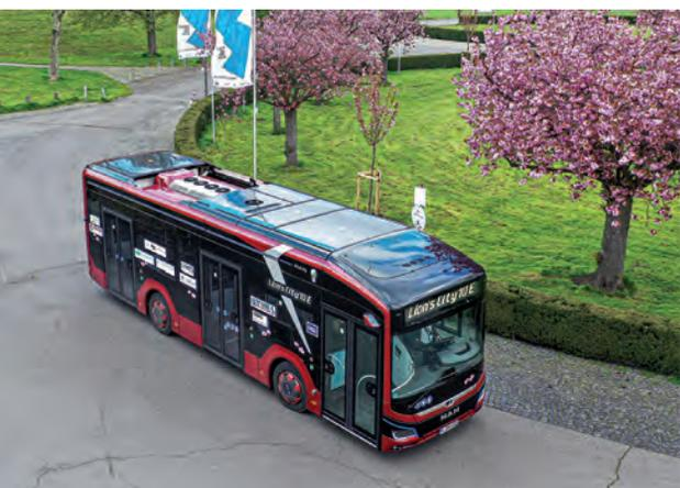
**EL LION'S CITY 10E, DE 10,5 METROS DE LONGITUD, TIENE UN RADIO DE GIRO DE SOLO 17,2 METROS. LA PROPULSIÓN SE REALIZA CON BATERÍAS DE 400 KWH DE CARGA, QUE BRINDAN UNA AUTONOMÍA DE 300 KILÓMETROS**
